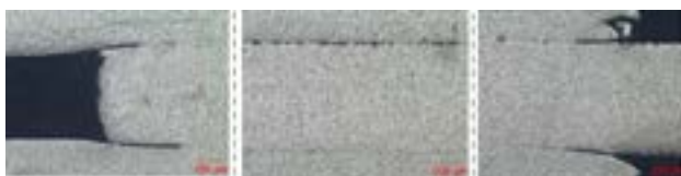
Рис. 5 - Макроструктура зразка зі сплаву ВТ-6 при T = 920^{\circ}\text{C}
